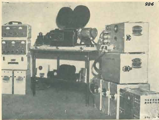
FIG. 8. - Sistema di registrazione sonora portatile Western Electric.
